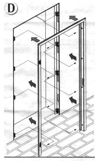
12. По отвесу или уровню установить стойки коробки строго вертикально и затянуть крепежные болты.
